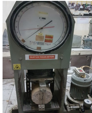
Gambar 3. Pengujian Kuat Tarik Belah
