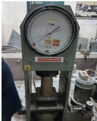
Gambar 2. Pengujian Kuat Tekan
