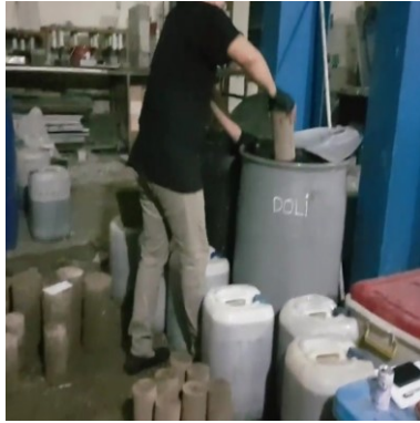
(b) Gambar 1. Perendaman sampel uji ke dalam bak perendaman (a) air biasa dan (b) gambut
