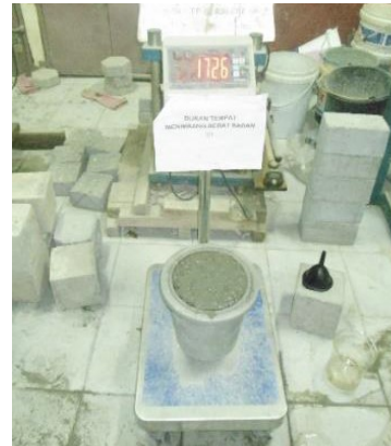
Gambar 6. Pengukuran Densitas Beton
