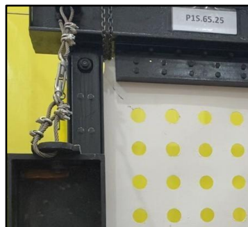
Gambar 7. Tekuk Awal Benda Uji P1S.65.25 pada Siklus 2A
