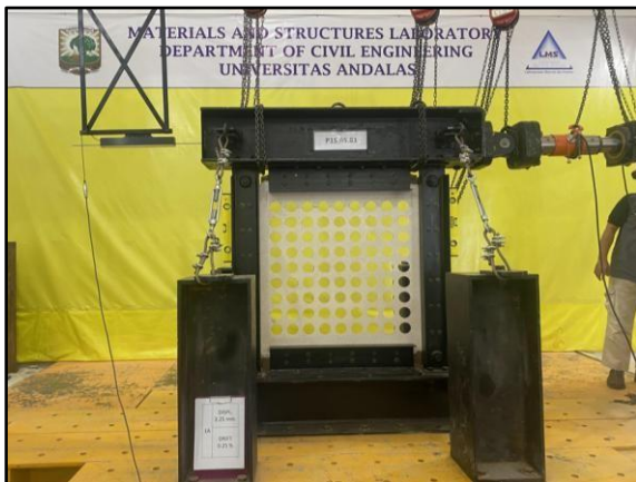
Gambar 2. Frame Dinding Geser Pelat Baja
