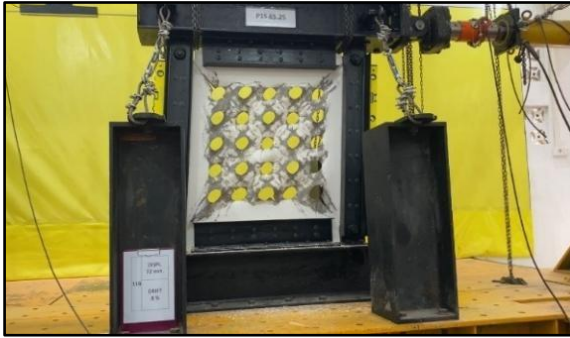
Gambar 11. Kondisi Benda Uji P1S.65.25 pada Tahap Akhir (Kondisi Fraktur)
